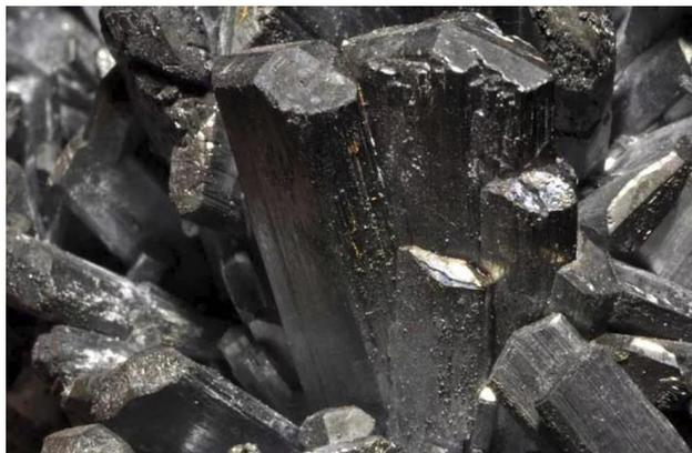
**Металлическая Сурьма** из-за своей хрупкости применяется редко. Однако, поскольку Сурьма увеличивает твердость других металлов (Олова, Свинца) и не окисляется при обычных условиях, Наша Компания нередко вводит ее в состав различных сплавов. Число сплавов, в которые входит Сурьма, близко к двумстам. Наиболее известные сплавы Сурьмы – **Твердый свинец**, **Типографский металл**, **Подшипниковые металлы** - Баббиты.
